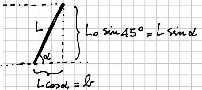
► Determina l'angolo di inclinazione dell'asta nel sistema di riferimento  $S$ .
